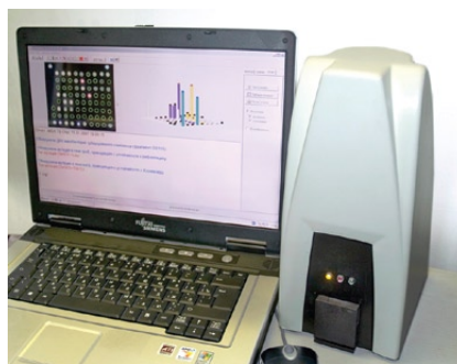
Рисунок 2. Универсальный аппаратно-программный комплекс для анализа биочипов.
